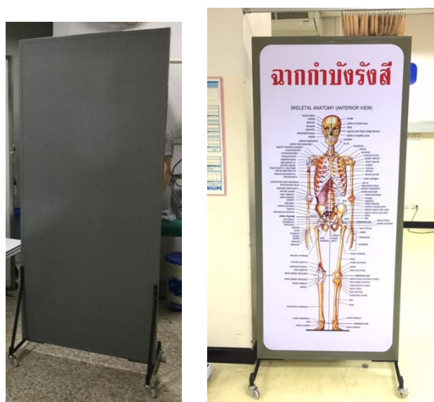
รูปที่ 3 แสดงฉากกำบังรังสีที่สร้างขึ้น
