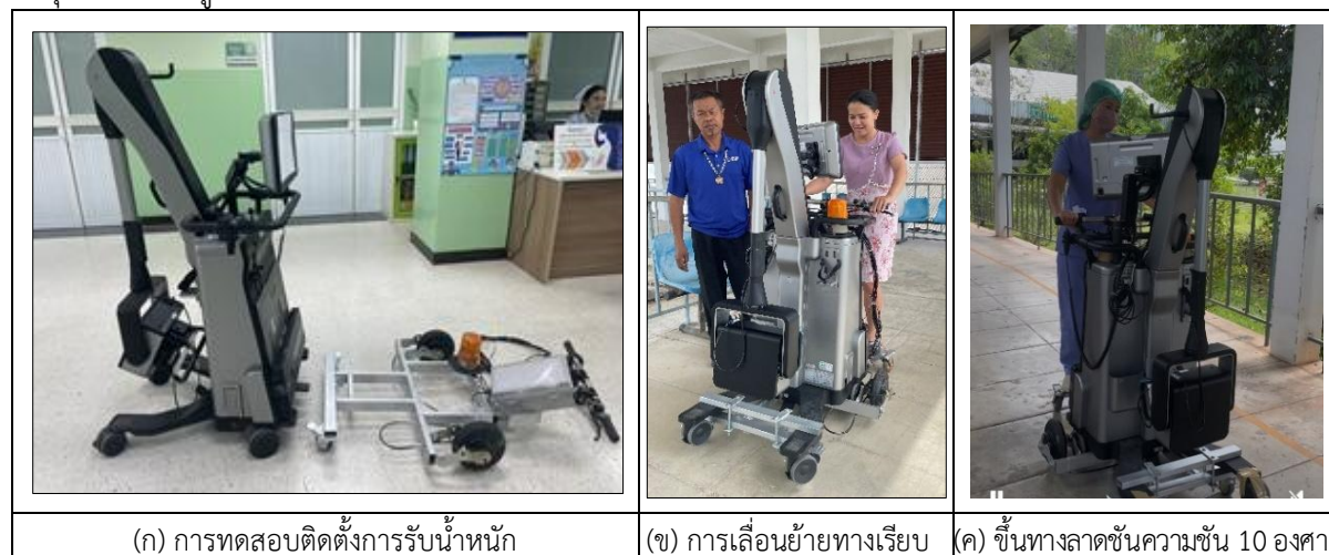
ภาพ 2 การทดสอบรถเข็นเครื่องเอกซเรย์เคลื่อนที่ด้วยมอเตอร์ไฟฟ้า (ที่มา: โรงพยาบาลมะเร็งสุราษฎร์ธานี)
