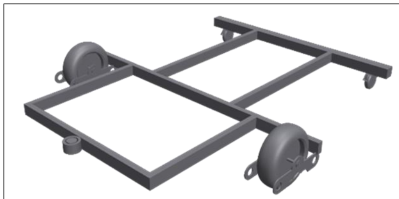
ภาพ 3 การออกแบบรถเข็นเครื่องเอกซเรย์เคลื่อนที่ด้วยมอเตอร์ไฟฟ้า (ที่มา :โรงพยาบาลมะเร็งสุราษฎร์ธานี )
