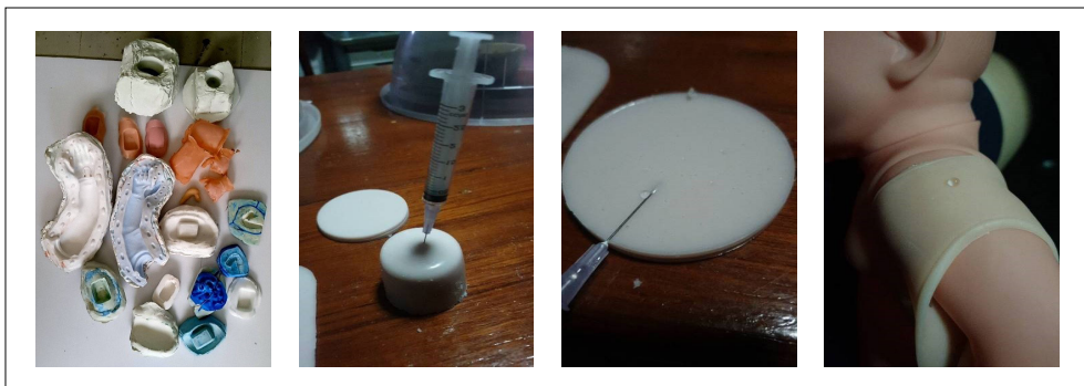
ภาพที่ 2 การหล่อซิลิโคนผิวหนังเฉพาะจุด
