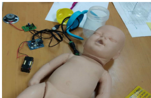
ภาพที่ 2 การประกอบหุ่น และการเชื่อมสายไฟจากส่วนลำตัวกับส่วนขาที่ฝังอุปกรณ์ระบบเซนเซอร์
