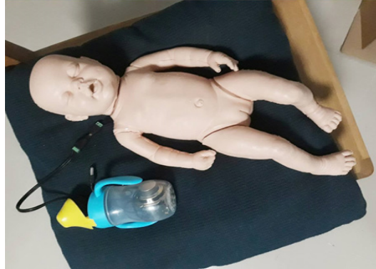
ภาพที่ 3 หุ่นทารกพร้อมลำโพงประยุกต์จากขวดน้ำดื่มสำหรับเด็กใช้จริง มีขนาดเหมาะสมและน้ำหนักเบา
