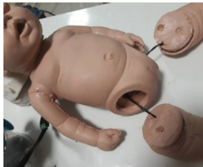
ภาพที่ 1 การหล่อหุ่นด้วยยางพาราผสมซิลิโคน และการขึ้นรูป
