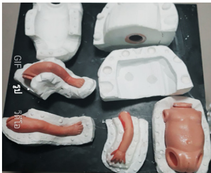
ภาพที่ 1 การหล่อหุ่นด้วยยางพาราผสมซิลิโคน และการขึ้นรูป
