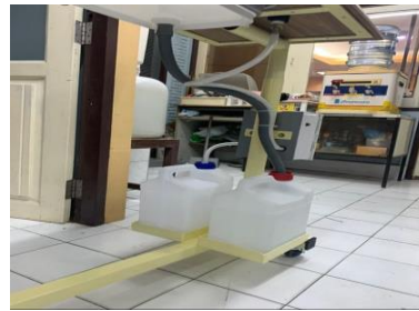
ภาพ 2 การทำฐานของตัวอ่างล้างหน้าเคลื่อนที่
