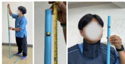
ภาพที่ 5 การติดตั้งโอเอสแอลนาโนดอทกับอุปกรณ์แทนผู้ปฏิบัติงานทางรังสีที่ระดับเลนส์ตา
