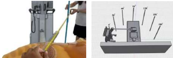
ภาพที่ 4 การกำหนดมุมติดตั้งโอเอสแอลนาโนดอท
