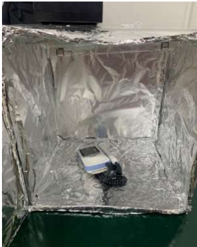
ภาพที่ 6 การทดสอบการทำงานของตู้อบทำลายเชื้อไวรัสโคโรนาด้วยรังสี UV-C กับ Probe วัดค่าของเครื่องมือทางการแพทย์
