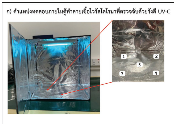
ภาพที่ 4 ตำแหน่งของการทดสอบการตรวจจับรังสี UV-C ภายในตู้ทำลายเชื้อไวรัสโคโรนา
