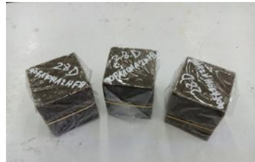
รูปที่ 2 การบ่มตัวอย่างจีโอพอลิเมอร์มอร์ตาร์ ขนาด 8x8x28 เซนติเมตร และขนาด 5x5x5 เซนติเมตร โดยใช้วิธีทำการปิดพลาสติกใส
