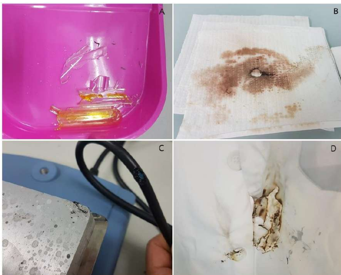
รูปที่ 3 อุบัติเหตุที่เกิดขึ้นในห้องปฏิบัติการ: หลอดทดลองแตก (A) รอยไหม้จากการนำกระดาษชำระเคมี (B) สายไฟเครื่องให้ความร้อนไหม้ (C) เสื้อคลุมปฏิบัติการไหม้จากตะเกียงแอลกอฮอล์ (D)
