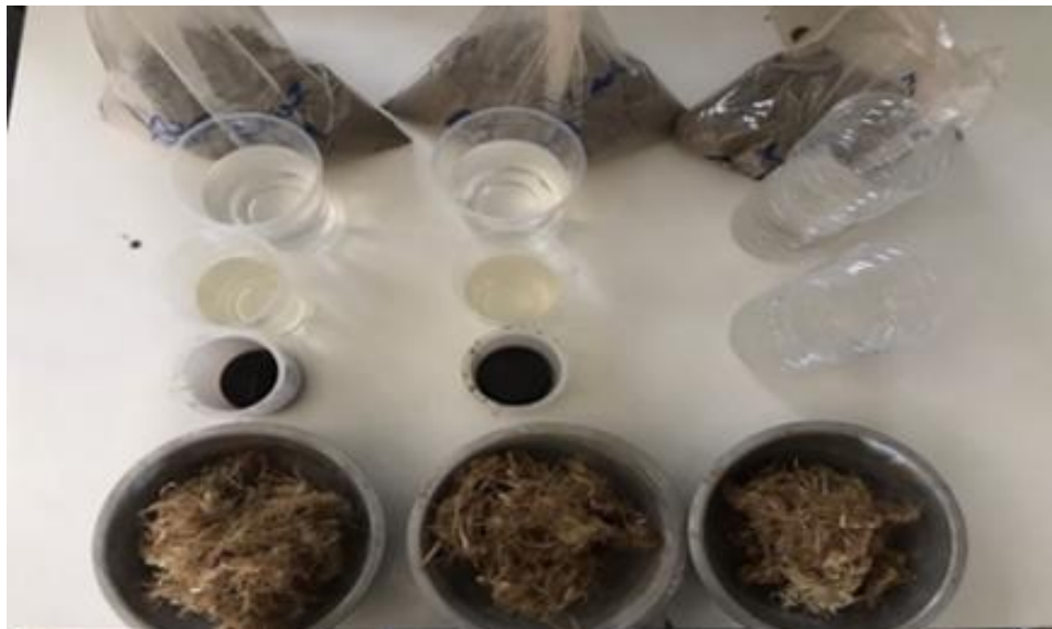
รูปที่ 1 ส่วนผสมจีโอพอลิเมอร์มอร์ตาร์ ประกอบด้วย เถ้าลอย (Fly Ash) เส้นใยกัญชง (Hemp fiber) โซเดียมไฮดรอกไซด์ (NaOH) โซเดียมซิลิเกต ( \text{Na}_2\text{SiO}_3 ) สารลดน้ำ (Superplasticizer) และน้ำสะอาด
