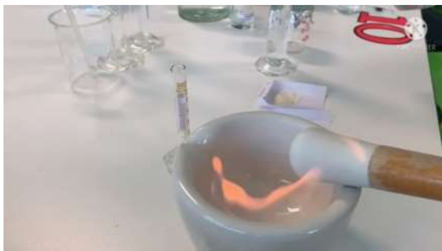
รูปที่ 2 การทำให้โกร่งและลูกโกร่งร้อนโดยการเผาด้วยเปลวไฟ
