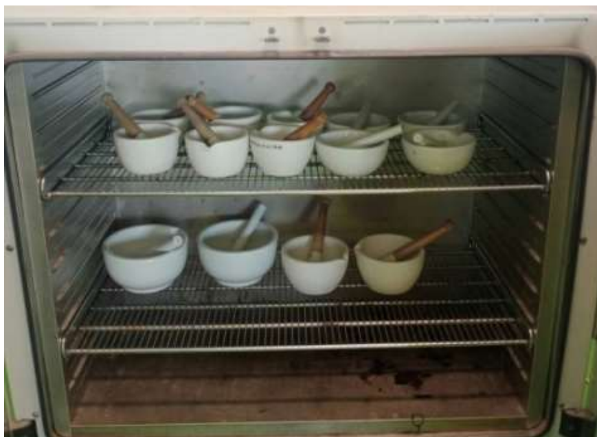
รูปที่ 1 การทำให้โกร่งและลูกโกร่งร้อนด้วยการอบในตู้อบลมร้อน
