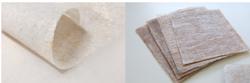
ภาพที่ 10 วัสดุจากกรรมวิธีการให้ความร้อนด้วยการรีดด้วยเตารีด ที่มา: [Onuma Wichaikul]
