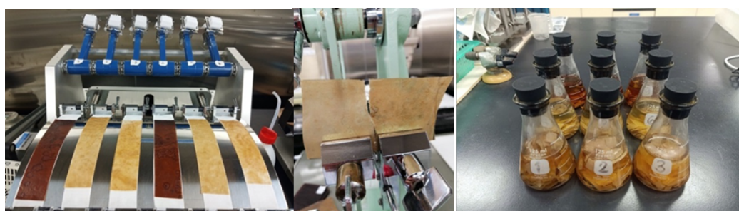
ภาพที่ 6 วัสดุสิ่งทอทดแทนเข้ารับการประเมินด้วยระบบมาตรฐานการทดสอบเจไอเอสประเทศญี่ปุ่น ประกอบด้วยหลักการทดสอบความคงทนยืดหยุ่น ความเหนียวทนทานต่อการฉีกหรือตัดเย็บ การซักล้าง และค่ากรดต่าง เรียงจากภาพซ้ายตามลำดับ
