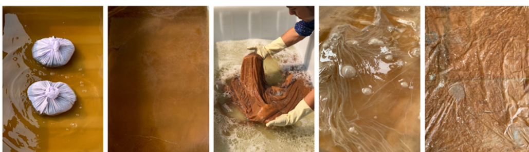
ภาพที่ 5 ภาพแสดงขั้นตอนการทดลองจนสู่ผลลัพธ์ เริ่มต้นจากการเตรียมสารตั้งต้นและสารประกอบซึ่งบรรจุลงในถุงผ้าฝ้ายดังที่ปรากฏในภาพแรกด้านซ้าย เรียงลำดับกันมาโดยนับจากขั้นตอนการกำเนิดรูป ควบแน่น และลดรูป
