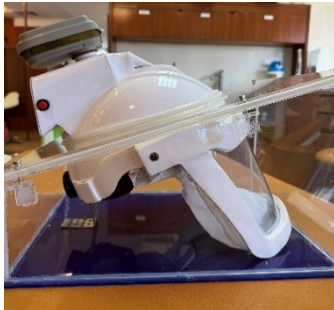
ภาพที่ 3 แสดงปุ่มเปิดชุดหน้ากากชนิดแรงดันบวก
