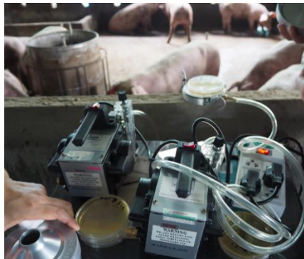
ภาพที่ 1 การเก็บตัวอย่างอากาศในโรงเลี้ยงสุกร
