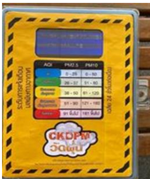
ภาพที่ 1 เครื่องมือตรวจวัด PM_{2.5} อย่างง่าย (CKDPM)
