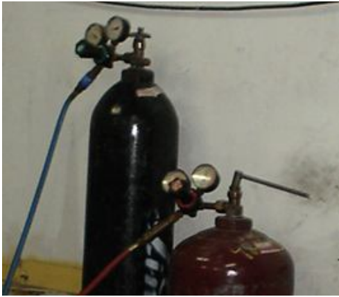
ภาพที่ 1 อุปกรณ์ในถังแก๊สออกซิเจนและแก๊สอะเซทิลีนสำหรับงานเชื่อม
