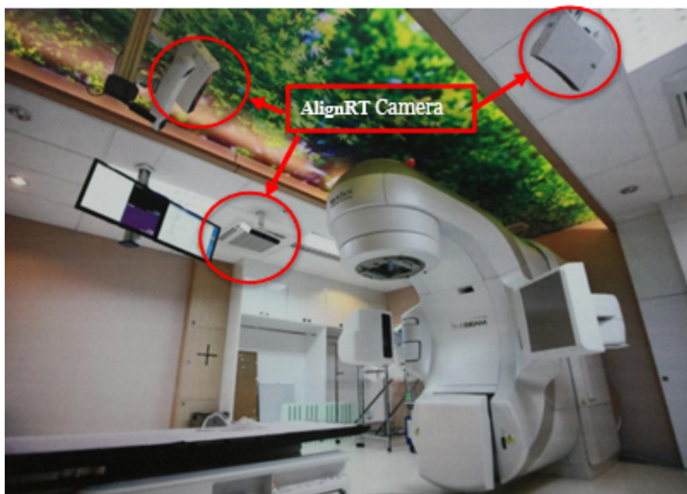
ภาพที่ 1 ระบบ AlignRT ติดตั้งร่วมกับเครื่องฉายรังสี Varian รุ่น TrueBeam
