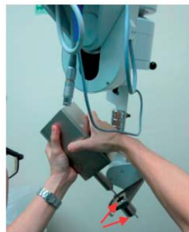
รูปที่ 7 แสดงการต่อหลอดรังสีเอกซ์เข้ากับขาตั้งต้องทำด้วยความระมัดระวังไม่ให้ปลายหลอดรังสีเอกซ์ กระแทกกับส่วนฐานข้อต่อบริเวณขาตั้ง (ลูกศร)
