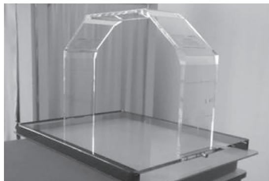
รูปที่ 2 เครื่องมือช่วยสร้างภาพ (localization jig)
