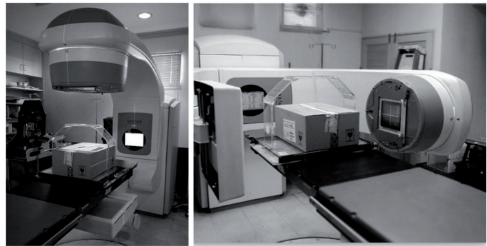
รูปที่ 3 ตำแหน่งหัวเครื่องจำลองการฉายรังสีถ่ายภาพรังสีทั้งเทคนิค VA และเทคนิค SO ของชุดอุปกรณ์สอดใส่สารกัมมันตรังสีซึ่งครอบด้วยเครื่องมือช่วยสร้างภาพที่ (ก.) มุม 0° และ (ข.) มุม 90°
