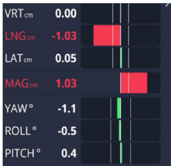
ภาพที่ 7 แสดงค่าที่ไม่อยู่ใน tolerance
