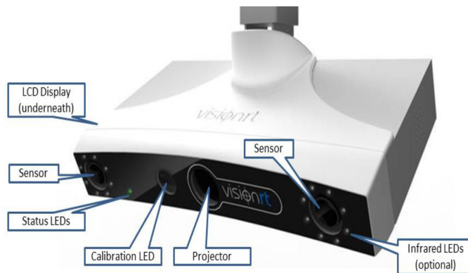
ภาพที่ 2 แสดง 3D camera units (Pods)
