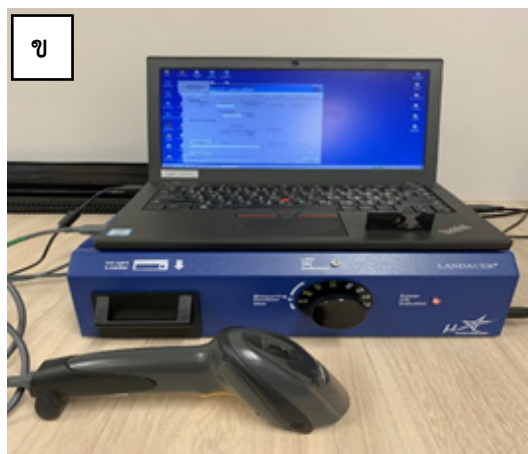
ภาพที่ 1 ชุดอุปกรณ์วัดปริมาณรังสีไอเอสแอล ชนิดนาโนดอท (Landauer Inc., Glenwood, IL, USA) (ก) แผ่นนาโนดอท (ข) เครื่องอ่านค่านับวัด รุ่น micro Star (ค) เครื่องล้างข้อมูลการนับวัด Annealer รุ่น InLight
