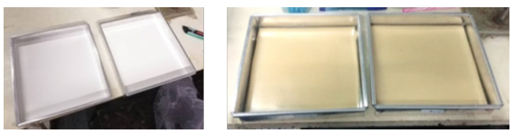
ภาพที่ 1 ส่วนผสมยางพาราธรรมชาติและโบลัสยางพาราธรรมชาติที่คงรูปในแม่พิมพ์
