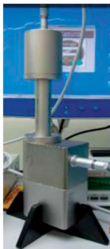
รูปที่ 3 แสดงอุปกรณ์ PDA ต่อกับหลอดรังสีเอกซ์ เพื่อปรับการเบี่ยงเบนของลำอิเล็กตรอนและตรวจสอบความสม่ำเสมอของการกระจายลำรังสี
