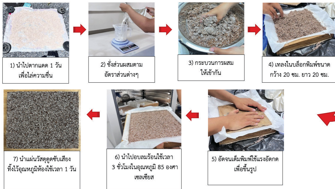
ภาพที่ 1 กระบวนการขึ้นรูปแผ่นวัสดุดูดซับเสียงจากเส้นใยคาบมะพร้าวและกากมะพร้าว
