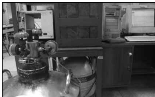
ภาพที่ 1 อุปกรณ์การวัดรังสี (Multi Channel Analyser : HPGe Detector (Bias-4000)) ยี่ห้อ : CANBARA (model 3105)
