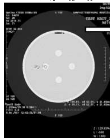
รูปที่ 1 ภาพเอกซเรย์คอมพิวเตอร์จากการสแกนแฟนทอม VCT QA phantom 5128754 ทำการวัดค่า CT number ตามตำแหน่งหมายเลข 1 (ROI) และ หมายเลข 2 (BG) ภาพนี้ได้จากการสแกนด้วย small body sFOV ที่ 120 kV 120 mA และ lung algorithm reconstruction
