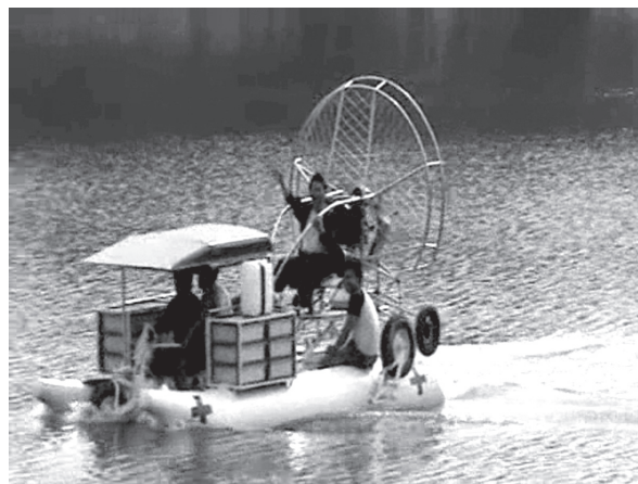
ภาพที่ 3 เครื่อง ABC. ขณะวิ่งสู่งพื้นที่น้ำท่วม จากนั้นระบบไฮดรอลิกจะพับล้อทั้ง 3 ล้อ ลอยลำเป็นเรือในน้ำ และขับเคลื่อนด้วยพลังลมจากเครื่องยนต์ดีเซล
