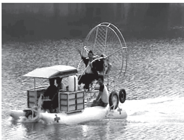
ภาพที่ 3 เครื่อง ABC. ขณะวิ่งสู่งพื้นที่น้ำท่วม จากนั้นระบบไฮดรอลิกจะพับล้อทั้ง 3 ล้อ ลอยลำเป็นเรือในน้ำ และขับเคลื่อนด้วยพลังลมจากเครื่องยนต์ดีเซล
