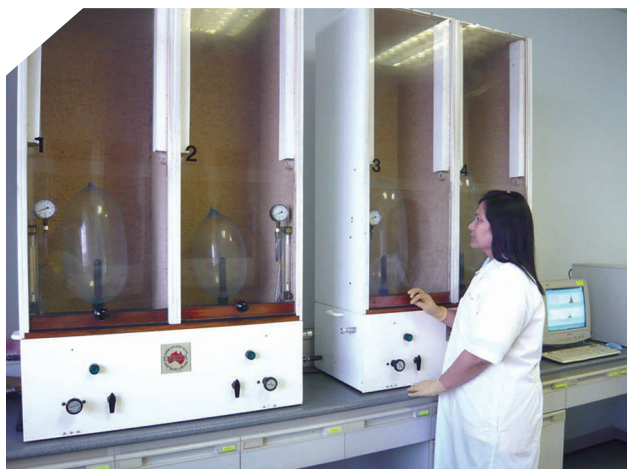
ภาพที่ 1 เครื่องทดสอบความทนความดันขณะแตกของถุงยางอนามัย
