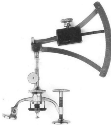
ภาพที่ 4 แสดง von Graefe's Tonometer (1863) ซึ่งใช้วัดความดันตาผ่านเปลือกตา (eyelid) หรือตาขาว (sclera) ในขณะนั้นยังไม่มียาชาเฉพาะที่สำหรับตาให้ใช้ (Available from: www.optvissci.com )
