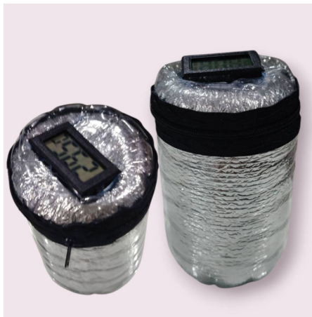
ภาพที่ 4 ติดตั้งเครื่องวัดอุณหภูมิดิจิทัล (Digital Thermometer)
