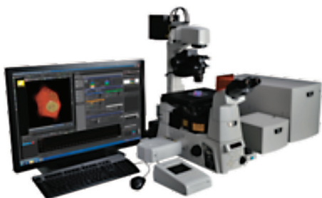
ภาพที่ 10 แสดงภาพของกล้องจุลทรรศน์แบบคอนโฟคอลชนิดที่ใช้เลเซอร์ในการสแกน (15)
