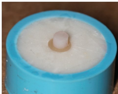
รูปที่ 2 ชิ้นงานเรซินคอมโพสิตชนิดฟิลเทกแซด 350 เอกซ์ที สี B1 ที่อุดลงบนพื้นผิวเรซินคอมโพสิตที่ผ่านการเตรียมมาแล้ว Figure 2 Filtek™ Z350 XT shade B1 specimen was filled on treated resin composite surface
