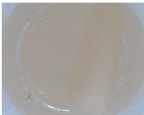
รูปที่ 7 แสดงความเชื่อมแน่นล้มเหลว พบการแตกในชั้นของเรซินคอมโพสิต สี A4
