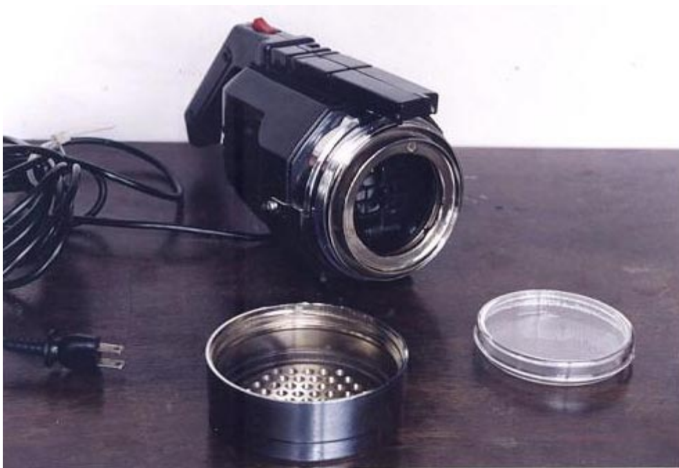
รูปที่ 1 ลักษณะเครื่องดูดฝุ่นที่ดัดแปลงหน้ากากเป็นฝาเกลียวเหล็กเจาะรู ชุบโครเมียม และทำแท่นวางจานอาหารเลี้ยงเชื้อ
