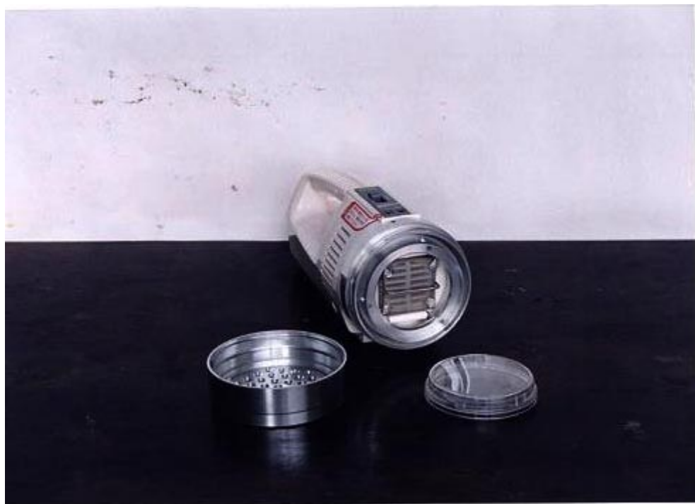
รูปที่ 2 ลักษณะเครื่องดักจับเชื้อในบรรยากาศ (Modified Anderson Sampler) แสดงหน้ากากฝาเกลียวและแท่นวางจานอาหารเลี้ยงเชื้อ
