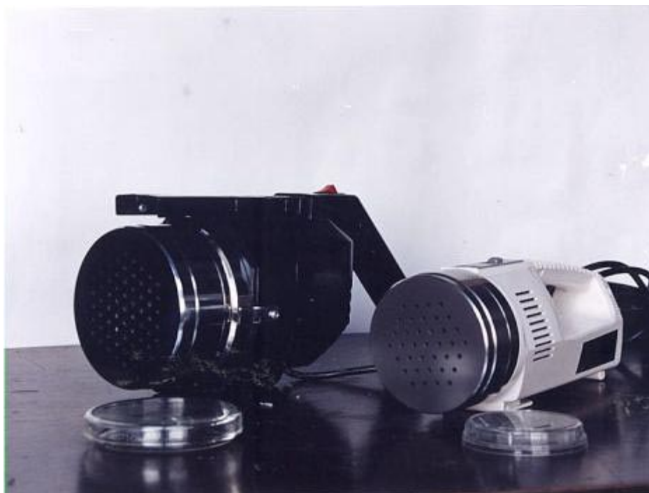
รูปที่ 3 เปรียบเทียบลักษณะและขนาดของเครื่องดัดแปลงกับเครื่องดักจับเชื้อในบรรยากาศ (Modified Anderson Sampler)
