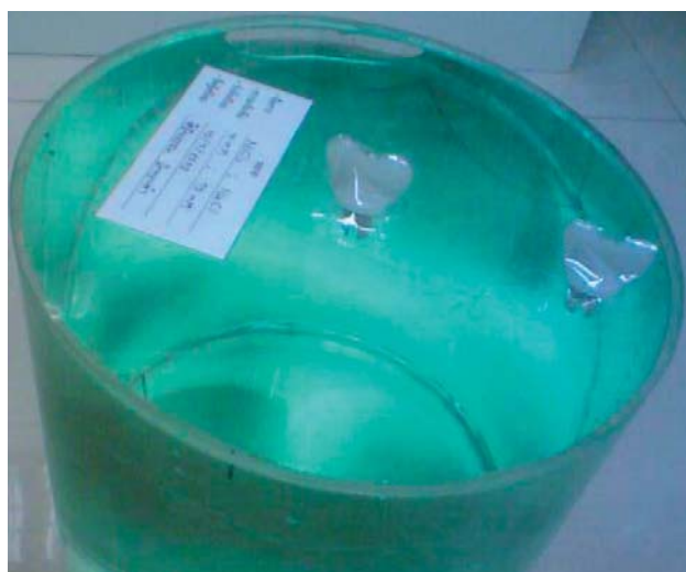
รูปที่ 1 หุ่นจำลองน้ำ ที่ประกอบด้วยสารละลายนิเกิลคลอไรด์ 10 มิลลิโมลาร์และสารละลายโซเดียมคลอไรด์ 75 มิลลิโมลาร์ในภาชนะที่ประดิษฐ์ขึ้น
