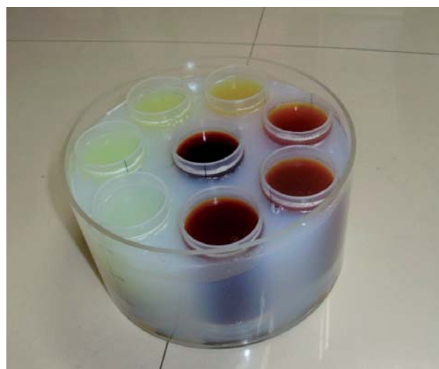
รูปที่ 2 หุ่นจำลองเจลที่เติมเฟอร์ริกคลอไรด์ (Ferric chloride, FeCl_3 \cdot 6H_2O ) ให้มีความเข้มข้นแตกต่างกัน 8 ความเข้มข้นในภาชนะที่ประดิษฐ์ขึ้น
