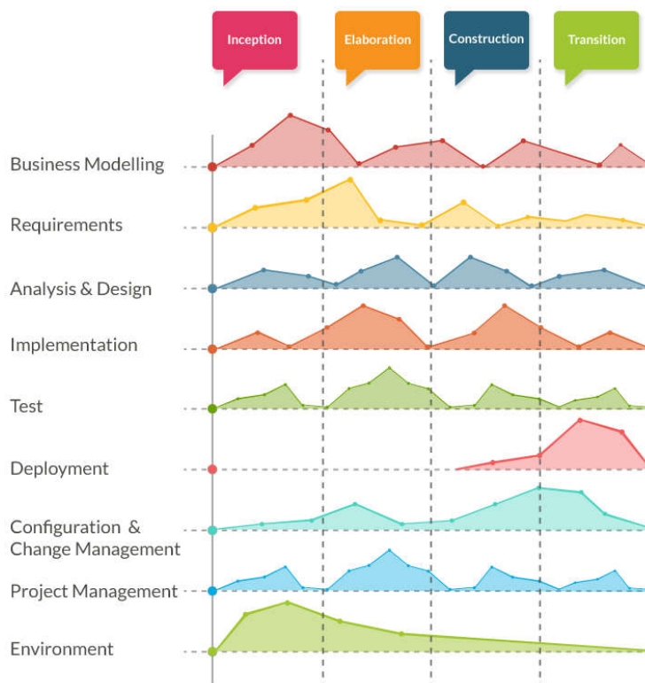
ภาพที่ 2 โมเดลการพัฒนาตามกระบวนการ Rational Unified Process (RUP) (Top 12 software, 2014)
