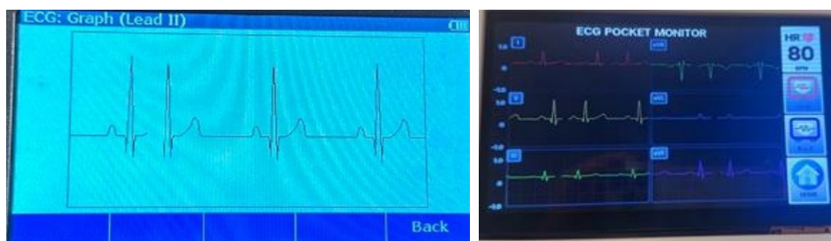
ภาพที่ 6 การแสดงผลบนหน้าจอ TFT ของเครื่องวัดสัญญาณคลื่นไฟฟ้าหัวใจแบบพกพา เทียบกับเครื่องจำลองสัญญาณคลื่นไฟฟ้าหัวใจ Fluke รุ่น ProSim8 ในรูปสัญญาณเป็น Normal Sinus Rhythm (NSR)
