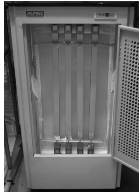
รูปที่ 1 การเสริมประสิทธิภาพโฟโตคะตะไลซิสบนแผ่นรองรับอนุภาคของเครื่องฟอกอากาศอิเล็กทรอนิกส์
