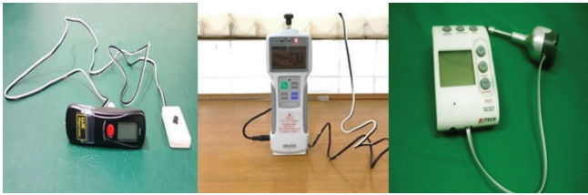
รูปที่ 1 เครื่อง WE (WE pressure pain threshold meter) (A), ตาชั่งมาตรฐาน DFG (digital force gauge) (B) และเครื่อง DA (digital algometer) (C)
