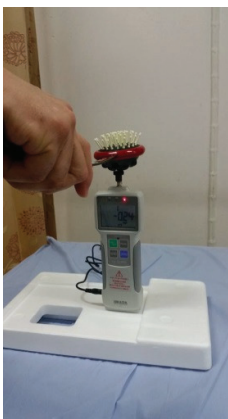
รูปที่ 3 เครื่องมือ digital force gauge และ electronic compact scale ในการควบคุมน้ำหนักของการเคาะ
