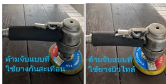
รูปที่ 3 การติดวัสดุลดความสั่นสะเทือนที่ด้ามจับ
