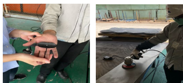
รูปที่ 4 การติดหัววัดและวัดค่าความเร่งความสั่นสะเทือน
