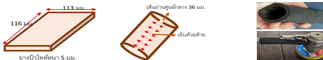
รูปที่ 8 ขั้นตอนการประกอบด้ามจับแบบที่ 2
