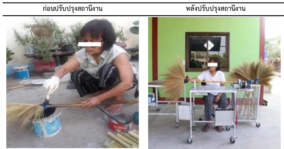
รูปที่ 2: การปรับปรุงสถานีนงานในขั้นตอนการทาเรนโค้ท
