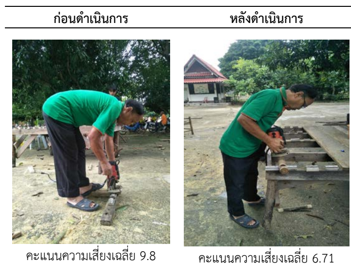
รูปที่ 2 การเปรียบเทียบ ผลการประเมินความเสี่ยงด้วยแบบประเมิน REBA ก่อนและหลังดำเนินการ
