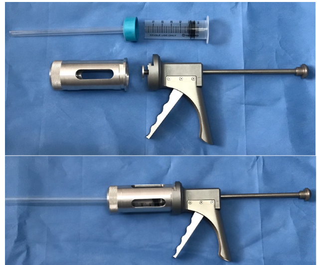
รูปที่ 1 ปืนฉีดซีเมนต์ LCG-MV มีส่วนประกอบคือ nozzle ผลิตจาก polyethylene tube, cartridge cap ใช้ฝาปิดเกลียวใน PVC ที่กลิ้งผิวด้านนอกทิ้งไป, cartridge เป็น 50-ml disposable syringe, cartridge cover เป็นโลหะทรงกระบอกที่กลิ้งขึ้นรูป สามารถประกอบเข้าและถอดออกจากด้ามปืนฉีดซีเมนต์ของบริษัท Beijing Marapole Technology ได้อย่างรวดเร็วและมั่นคง
