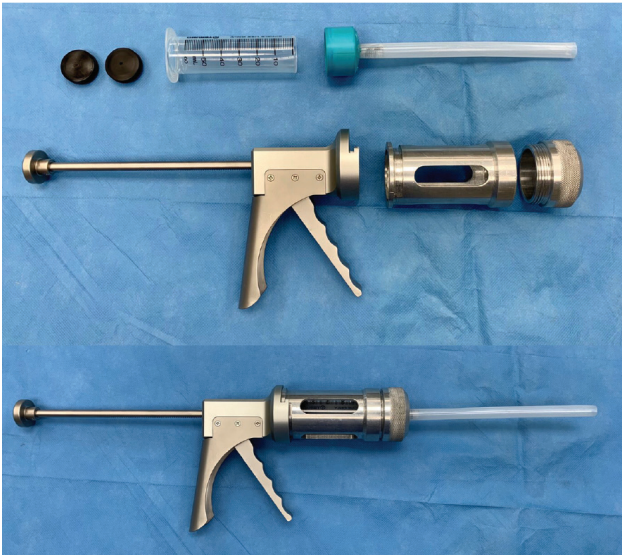
รูปที่ 1 ปืนฉีด LCG-MV มีส่วนประกอบคือ nozzle ผลิตจาก polyethylene tube, cartridge cap (ฝาปิดเกลียวใน PVC), cartridge (50-ml disposable syringe), cartridge cover เป็นโลหะทรงกระบอกที่กลิ้งขึ้นรูป สามารถประกอบเข้าและถอดออกจากตัวปืนฉีดซีเมนต์ของบริษัท Beijing Marapole Technology ได้อย่างรวดเร็ว
