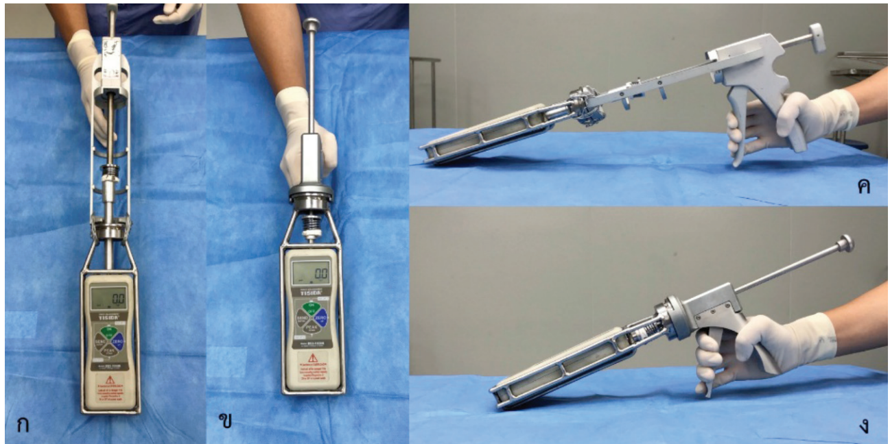
รูปที่ 4 การทดสอบแรงบีบสูงสุดของไวกิ้งของปืนฉีด Optigun® (ก,ค) และ LCG-MV (ข,ง) ด้วยเครื่อง digital force gauge
