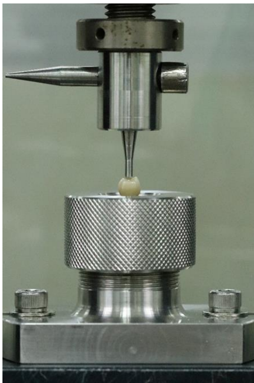
รูปที่ 2 การทดสอบความต้านทานการแตกหัก Figure 2 Fracture resistance testing
