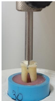
รูปที่ 3 การทดสอบความแข็งแรงพันธะผลึกออกโดยใช้เครื่องทดสอบสากล Figure 3 Push-out bond strength test by using universal testing machine
