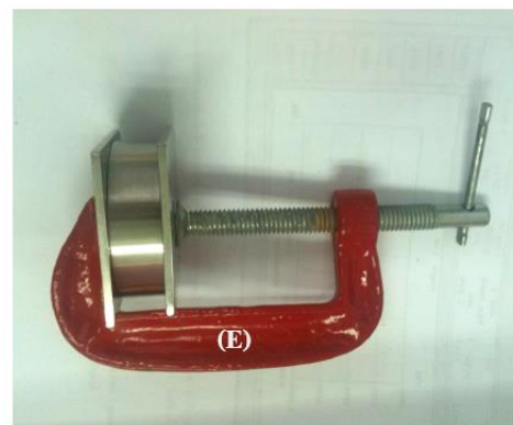
รูปที่ 1 อุปกรณ์ที่สร้างขึ้นทดสอบการเกิดฟองอากาศ (A) วงแหวนสำหรับยึด (B) แม่แบบทำขึ้นตัวอย่างส่วนบน (C) แม่แบบทำขึ้นตัวอย่าง ส่วนล่าง (D) แผ่นโลหะแบนราบ (E) อุปกรณ์ยึดแม่แบบ
